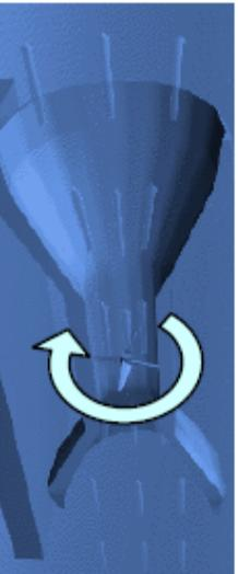
4) Les hydroliennes qui exploitent « l'effet Venturi », c'est-à-dire l'accélération d'un fluide dans une conduite dont le diamètre se rétrécit.
