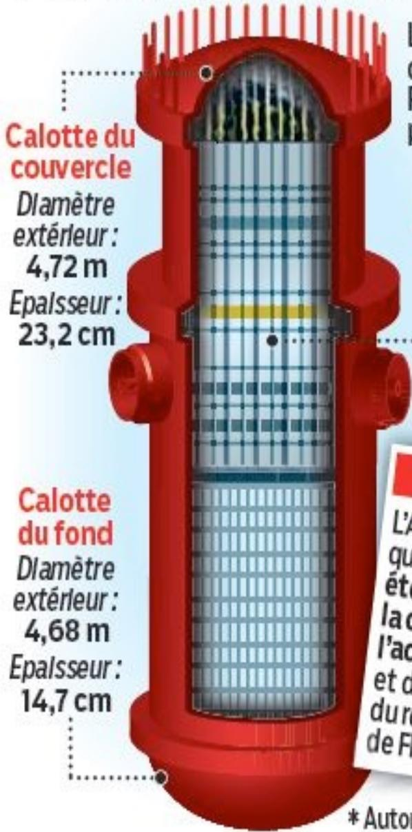
Le couvercle et le fond de la cuve de l'EPR de Flamanville sont des pièces en acier forgé.
