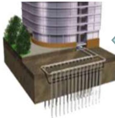
**Fermé.** Le fluide n'est pas en contact avec le sol ou la nappe. Il récupère par exemple l'énergie solaire d'été voire injecte de la chaleur excédentaire. *Le champ ou les fondations thermo-actives vont couramment à 200kW et plus. Elles fonctionnent partout ou presque.*
