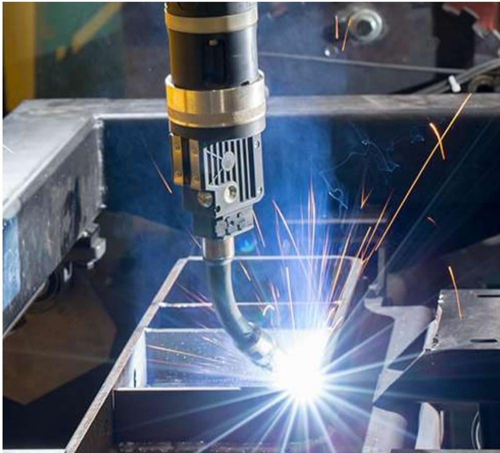
Soudure de pièce acier. La partie usinée (chantiers navals) est plutôt élevée, avec des possibilités de robotisation pour les caissons (cf. CNM Cherbourg ou STX à Saint-Nazaire)
